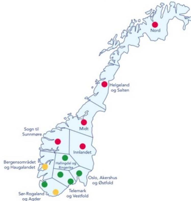
Figur 3 Statnetts oversikt over hvor det er mulig å reservere kapasitet ut over vanlig forbruk per september 2024
